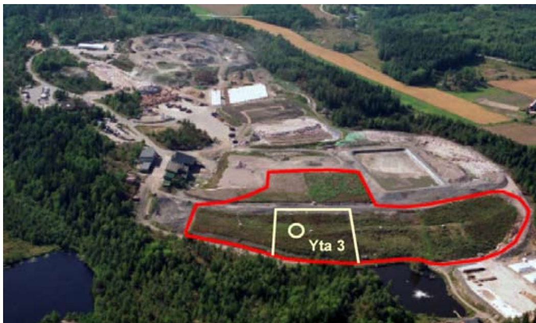
Figur 1 Ovan. Flygbild över Tveta Återvinningsanläggning med askupplaget i bakgrunden och östra slänten med de sju ytorna med sluttäckningsförsök inramade med rött i förgrunden. Försöken med impedansspektroskopi ägde rum vid den runda ringen i yta tre, se gul markering på fotot.
