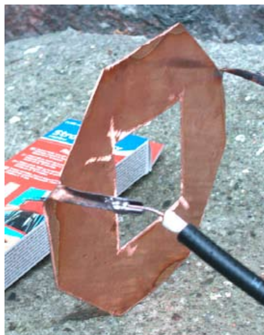
Figur 25. En av kopparelektroderna som anslutits med hårdlödningar till ledarna i signalkablar. Ledarna dubblerade för redundans. Lödskarvarna täcktes sedan med ytterrör av plast vilka fylldes med epoxi.
