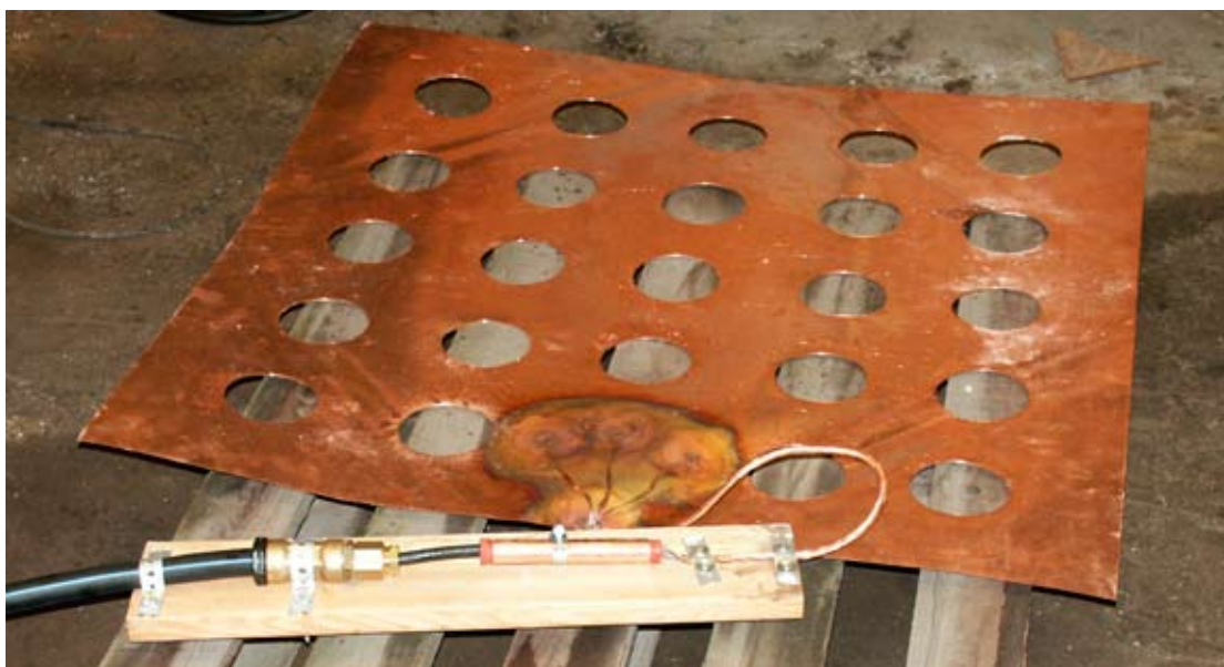
Figur 31. Kopparplatta med tillhörande koppling till koaxialkabel. Denna skyddas av ett vattenledningsrör, vilket framgår nertill till vänster på bilden. Detaljer kring hur kopplingen framgår av Figur 31. Anordningen är robust utformad med tanke på att den skall fungera även efter intensiva successiva kompakteringar av tätskiktet med en stor vibrationsväkt.
