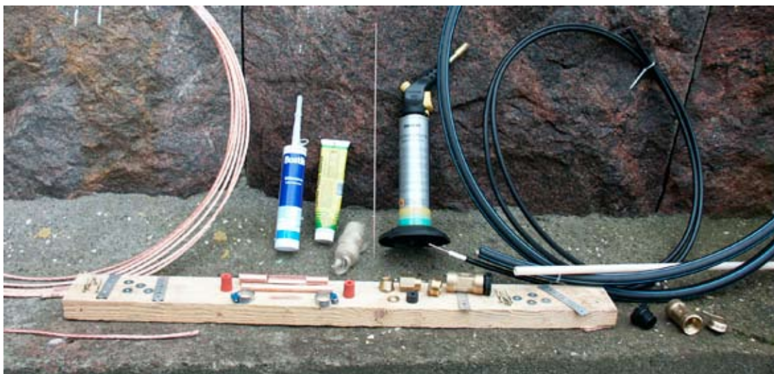
Figur 32. Armaturer för fogning av kopparelektroder och koaxialkabel. Förbandet varmlöddes och inneslöt i en bit kopparrör som fylldes med tätningsmassa.
