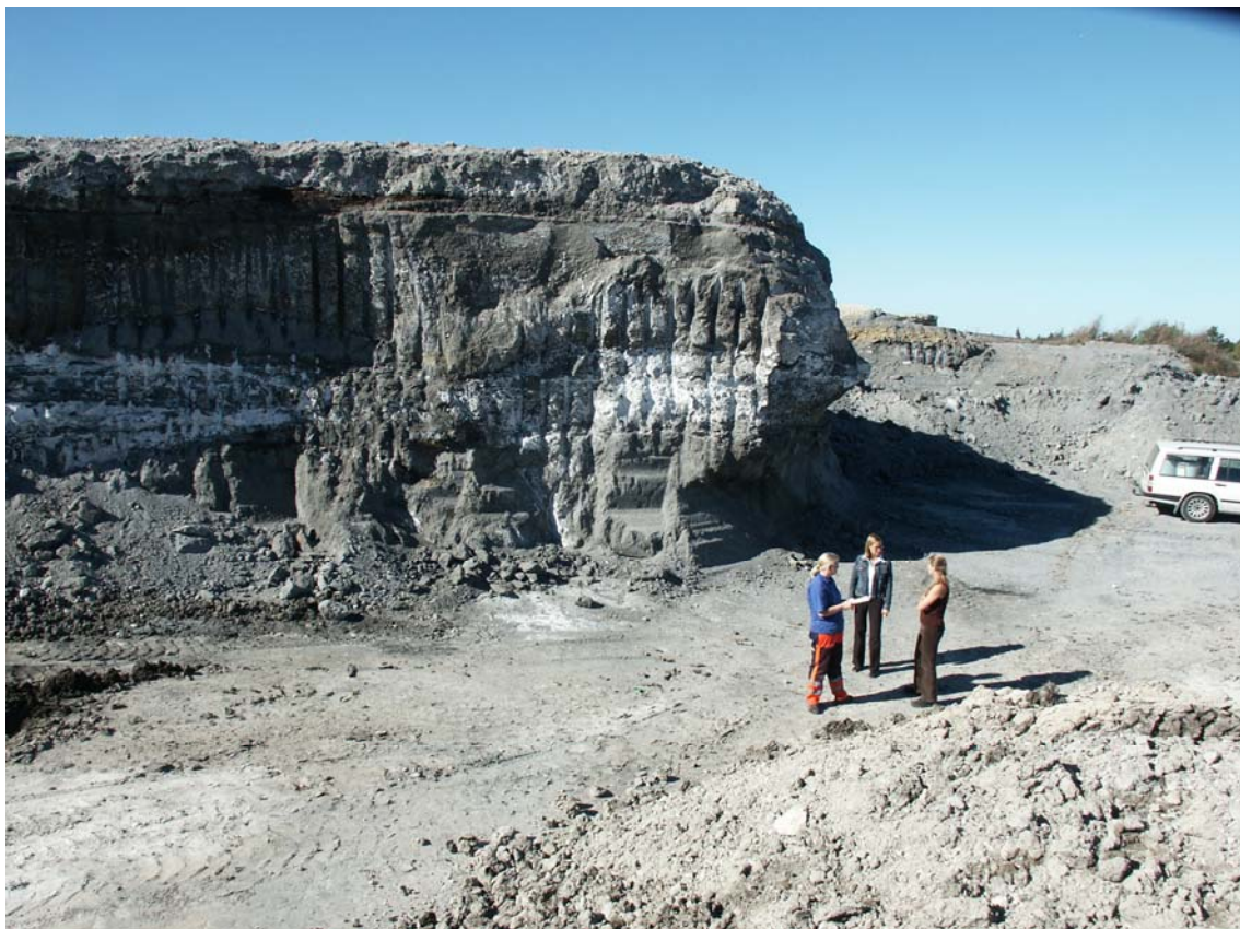
Figur 4. Aska i upplaget hos Tveta Återvinningsanläggning med en kraftig konsolidering trots obetydlig karbonatisering.
