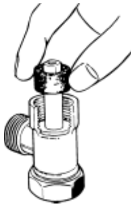
Figur 9. Grafitbaserad packning med säte, enligt [18]. Graphite-based packing assembly according to [18].
