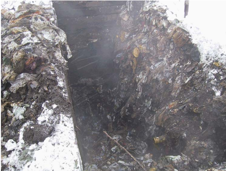
Figur 25. Testcell med organiskt avfall på Tveta Återvinningsanläggning där injektering skedde under pilotförsöken.
