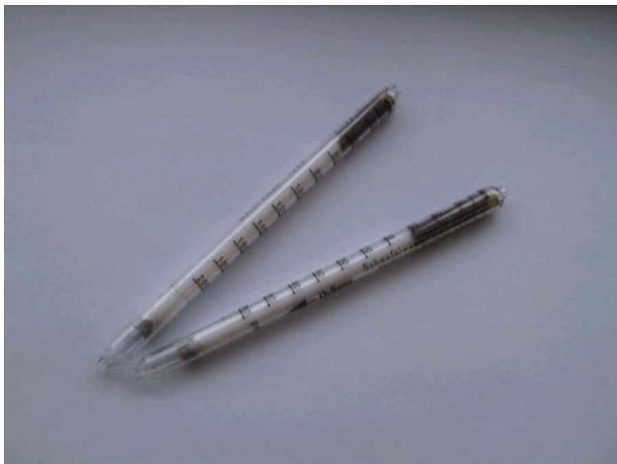
Figur 49. Drägerrör efter gasprovtagning. Avläsning på skalan för det mörkfärgade området ger H_2S -halten.
