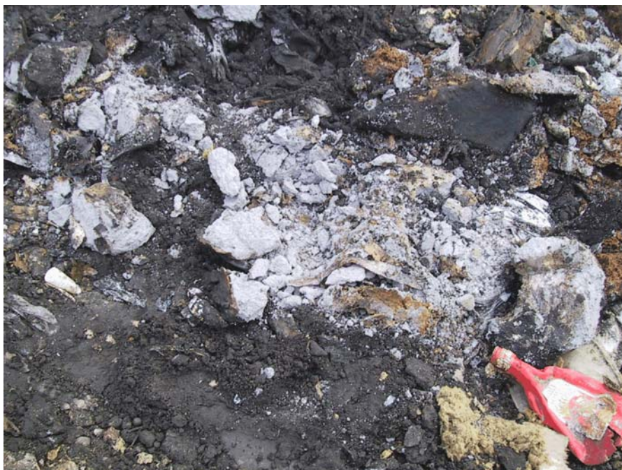
Figur 6. Klumpar av stelnad aska vid 4,5 meters djup framför hål 4. Askan härstammade dock troligtvis inte från hål 4 eftersom detta hål endast injekterats vid 9 meters djup.
