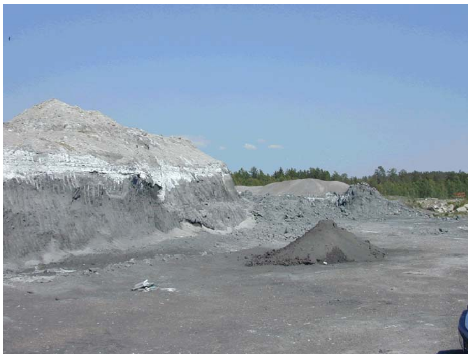
Figur 15. Askupplag på Tveta Återvinningsanläggning 2002-05-30. Den ljusa askan är flygaska medan den lilla högen med mörkare aska är blandad bottenaska.
